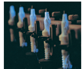
Comprobación de aisladores a 40.000 voltios: Las bujías de encendido BERU deben demostrar su fiabilidad en el banco de pruebas antes de la fabricación en serie.
