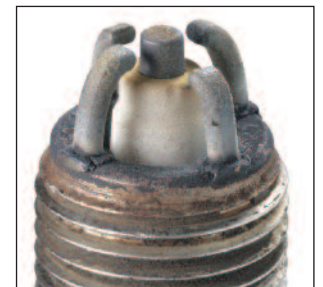
Una bujía de encendido Ultra X, cambiada durante la inspección: El aislante no tiene sedimentos, y el electrodo de masa y el central presentan un reducido nivel de quemadura.
