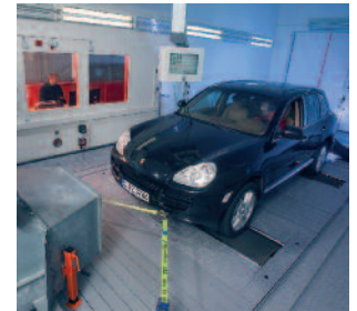
En el banco de pruebas por rodillos de dos ejes en el centro de investigación y desarrollo de BERU en Ludwigsburgo se comprueban las características de arranque en frío de las bujías de encendido.
